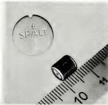
Bild 7. Die Pertrix-Endo-Radiozelle im Größenvergleich zu einer Tablette
