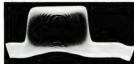
Bild 2. Impulsfolge am Wehneltzylinder der Bildröhre zur Hellsteuerung einer Kreisfläche (nach Gleichung 1 und 2). Zur besseren Erkennbarkeit wurde ein Teil der Impulsfolge ausgetastet. Die Ablenkfrequenz des Oszillografen entspricht der Zeilenfrequenz
