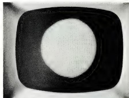
Bild 1b. Bei richtiger Abstimmung erhält der Kreis seinen maximalen Durchmesser
