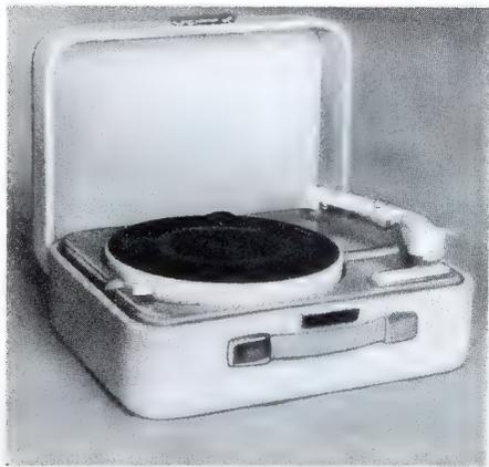
Bild 1. Koffer-Plattenspieler Wumo-Solorette 2 mit Aufsetztaste, mit deren Hilfe der Abtast-Saphir genau am Plattenanfang aufgesetzt werden kann
