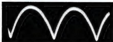
Bild 5. Parabel-Impulse an den Siebgliedern der Vertikal-Ablenk-Stufe. Sie dienen als Steuerimpulse für die Flip-Flop-Stufe (Bild 3); Impulsdauer: 20  $\mu$ s
